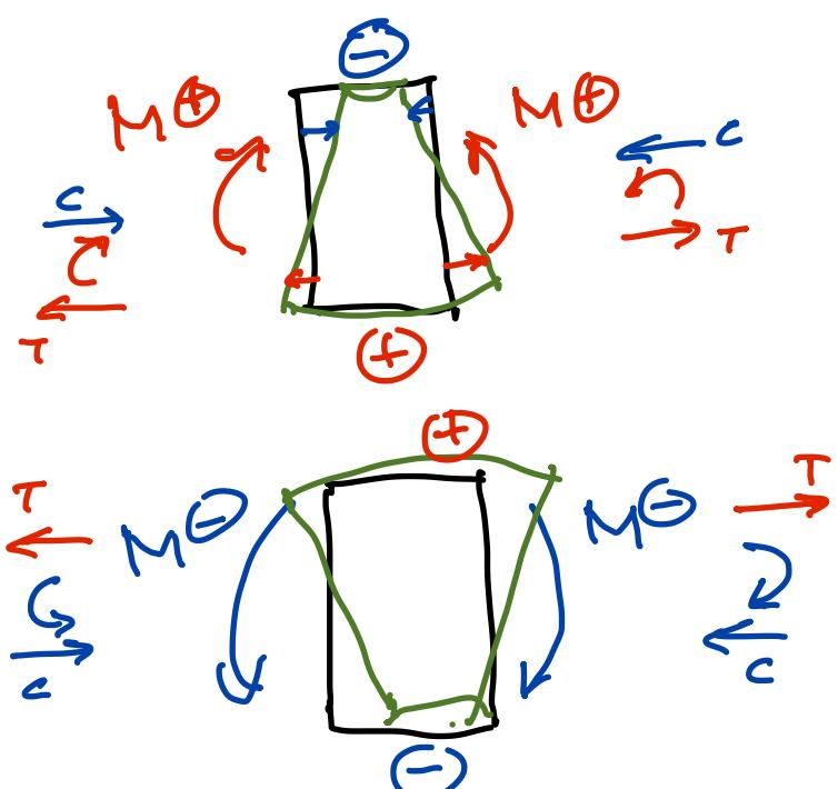
O diagrama de momentos flectores é trazado do lado da fibra tracionada
