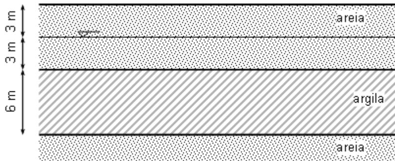
Determine numericamente a distribuição de excesso de poropressão na camada de argila ao longo de 10 anos em intervalos de 1 ano. Utilize:
