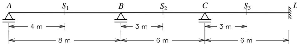
As envoltórias de valores mínimos e máximos de momentos fletores devem ser traçadas com base em valores calculados nas seções  $S_1$ ,  $B$ ,  $S_2$ ,  $C$ ,  $S_3$  e  $D$ . Momentos fletores são considerados positivos quando tracionam as fibras inferiores e negativos quando tracionam as fibras superiores.
